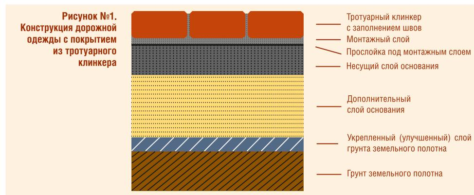
**Несущее основание** – часть дорожной одежды, обеспечивающая совместно с покрытием перераспределение и снижение давления на нижележащие дополнительные слои или грунт земляного полотна. Основание может быть выполнено из различных материалов: щебня, укладываемого с расклинкой; песко-цементной смеси; щебня, укрепленного цементом или расклинованного песко-цементной смесью или других материалов, модуль упругости которых превышает 180 МПа.
