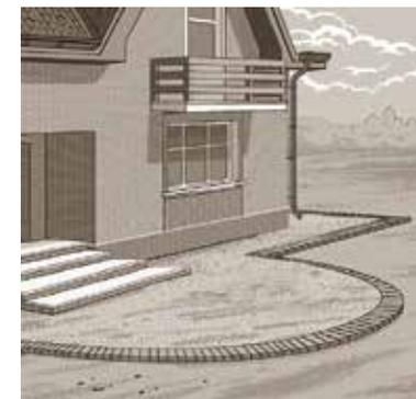
Вид бордюра с уплотненным несущим слоем. Поверхность подготовлена к устройству монтажного слоя и мощению.
