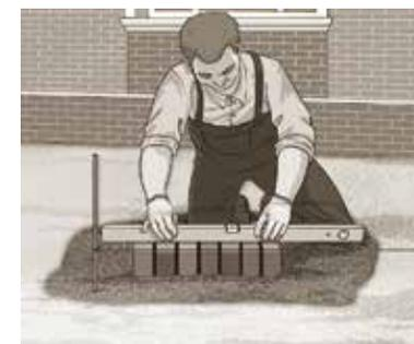
Бордюр формируется укладкой клинкера на ребро. Возможны и другие варианты: установка клинкерных кирпичей на тычок (вертикально) или использование специальных бордюрных камней.
