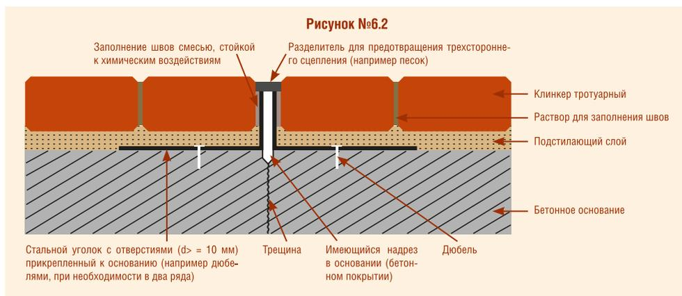
Стальной уголок должен иметь отверстия, длина горизонтальной полки должна составлять не менее трехкратного значения высоты кирпича, но не менее 200 мм. Длину вертикальной стенки уголка выбирают таким образом, чтобы в установленном состоянии она закрывала примерно 2/3 толщины клинкера. Для предотвращения возможного изменения цвета светлого клинкерного покрытия из-за образования ржавчины, стальной уголок должен иметь достаточную антикоррозионную защиту.
