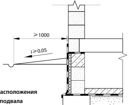
Рис. 4.2. Схема расположения гидроизоляции подвала
