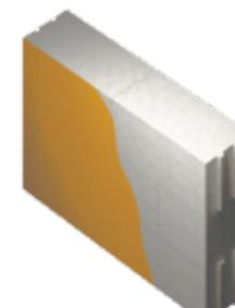
2.2. Штукатурка с последующим декорированием (окраска, о fakturiruvaniye). Универсальный вид отделки. Требования: невысокие прочность и модуль упругости, для стен отапливаемых зданий — достаточная паропроницаемость. Пожелания: ограниченное водопоглощение, определенные адгезия и морозостойкость контактной зоны.
