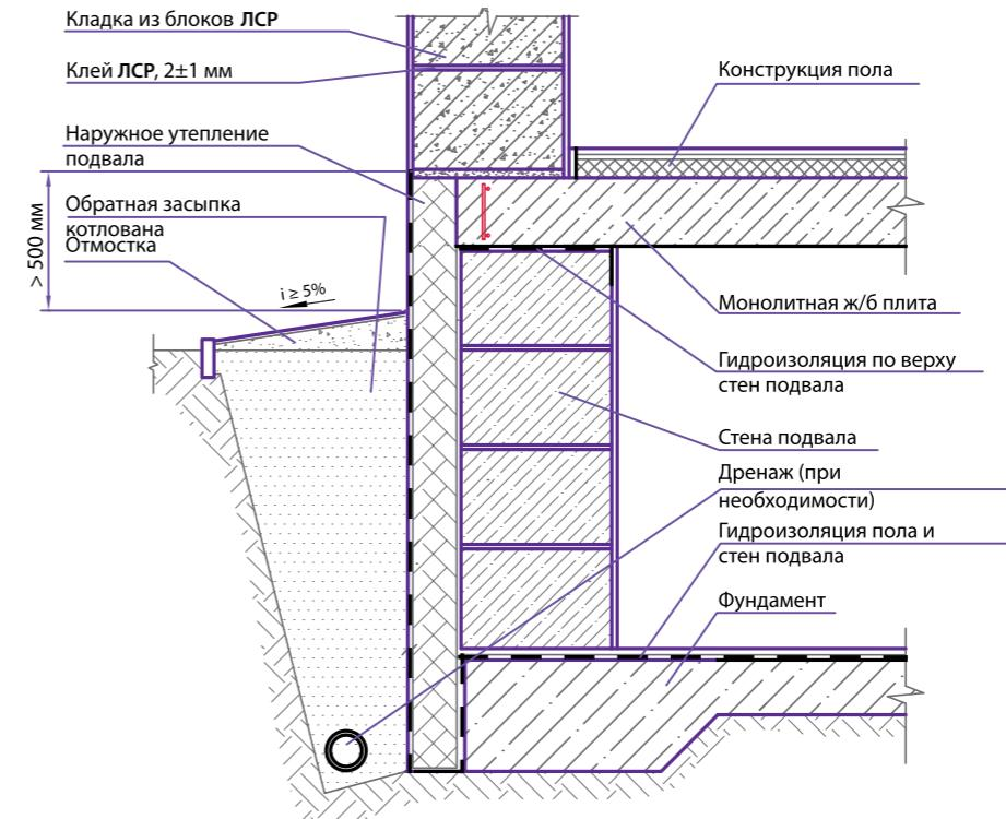
**Наружная стена подвала из бетонных блоков или кирпича с монолитным железобетонным перекрытием**
