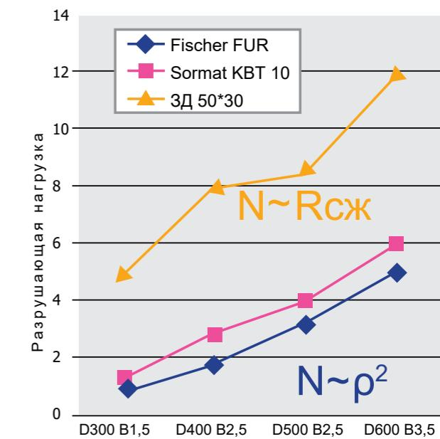
Для решения большинства задач, возникающих в индивидуальном строительстве и в быту, подходит дюбель Sormat KBT, вкручиваемый в заранее высверленное отверстие. Расчетные нагрузки на вырыв приведены в таблице 11.
