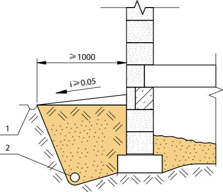
Рис. 4.1. Схема устройства дренажа:
