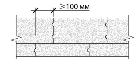
Рис. 4.4. Перевязка кладки
