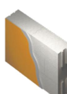
2.3. Облицовка керамической плиткой или каменными плитами, облицовка кирпичом без зазора.
