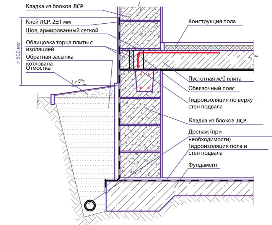
**Наружная стена подвала из блоков ЛСР с перекрытием из ж/б плит**
