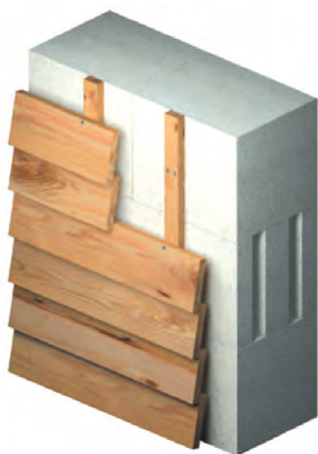
Рис. 7а. Облицовка по направляющим
