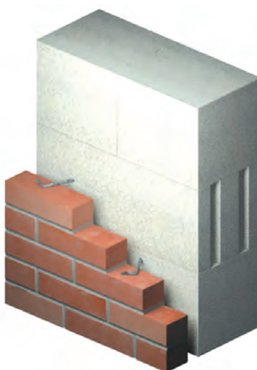
Рис. 7б. Облицовка с непосредственным креплением
