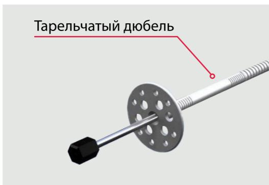
Фиксирующий блок дюбель должен быть утоплен таким образом, чтобы его шляпка была заподлицо с поверхностью теплоизоляционного блока. После проведения механической фиксации, выровнять возможные неровности с помощью терки.
