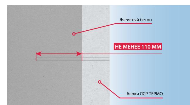
Для фиксации утеплителя к плотным материалам стены необходимо использовать винтовые или забивные дюбеля с обычной распорной зоной. Для фиксации к пустотелым материалам стены необходимо использовать винтовые дюбеля с удлиненной распорной зоной. Для фиксации утеплителя к пористым материалам стены необходимо использовать винтовые дюбеля для ячеистых бетонов.
