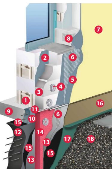
Рис. 5. Система фасадного утепления стен ЛСР ТЕРМО
