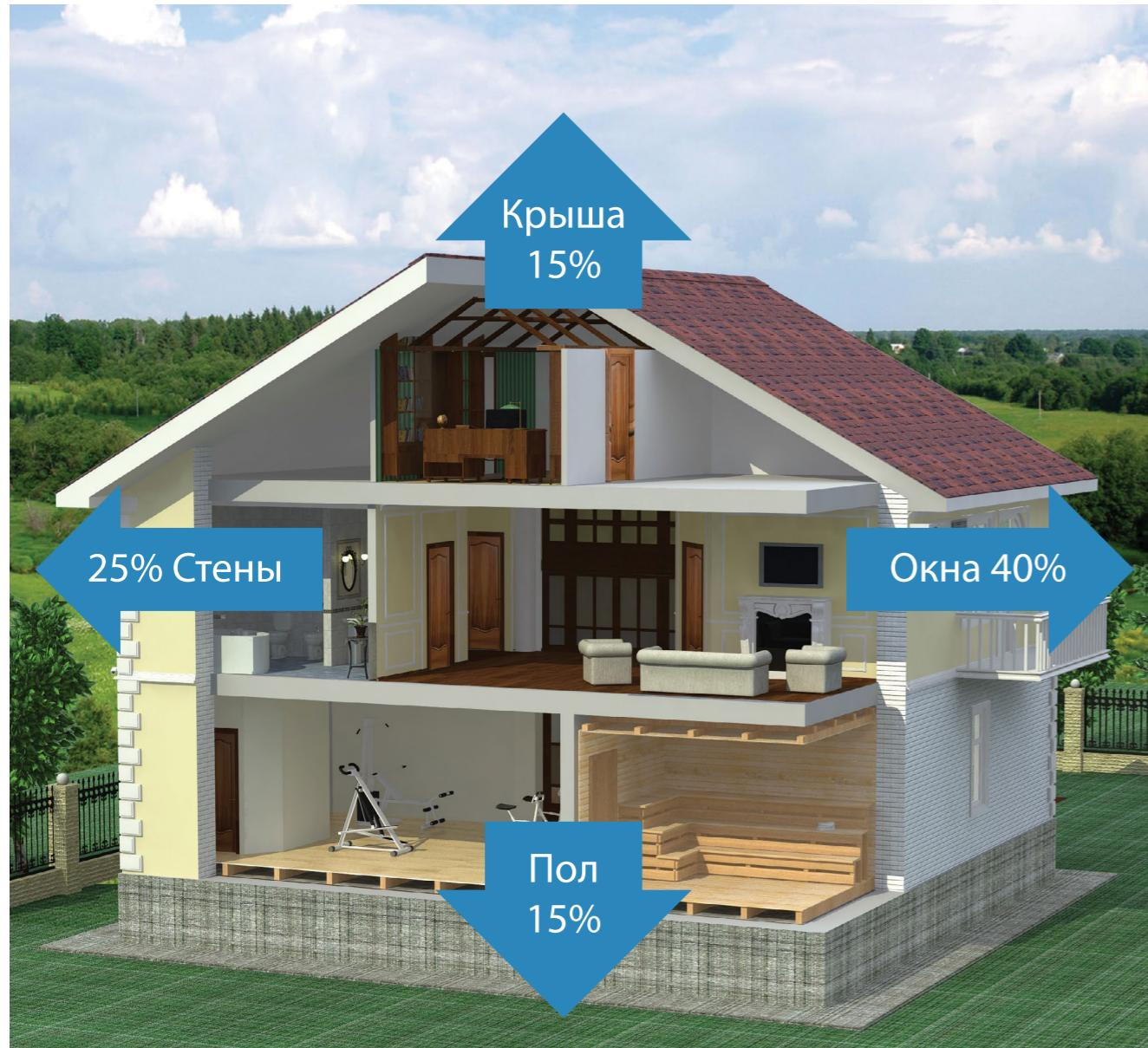
Рис.1. Структура теплопотерь через ограждающие конструкции в доме
