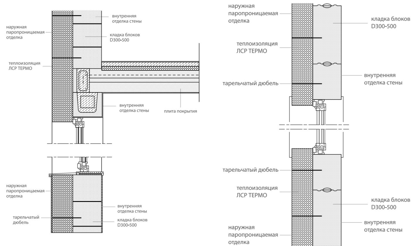
**Наружная стена из газобетона ЛСР с внешним
