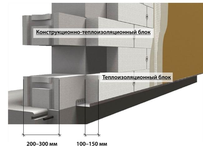
Рис. 4. Энергоэффективные двухслойные стены из газобетона с внешним утеплением ЛСР ТЕРМО
