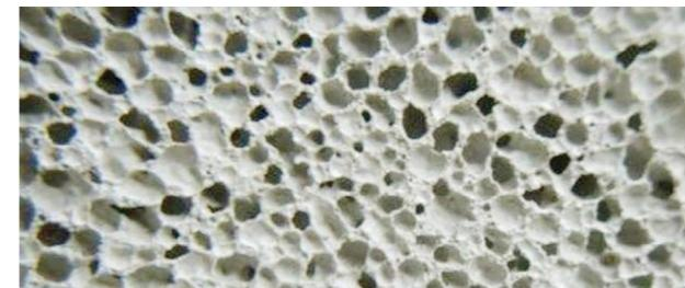
Автоклавная обработка сырого массива при температуре 190°C и давлении 12 ат. обеспечивает декларируемую прочность и долговечность минерального утеплителя ЛСР ТЕРМО.
