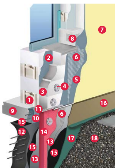
Рис. 5. Система фасадного утепления стен ЛСР ТЕРМО
