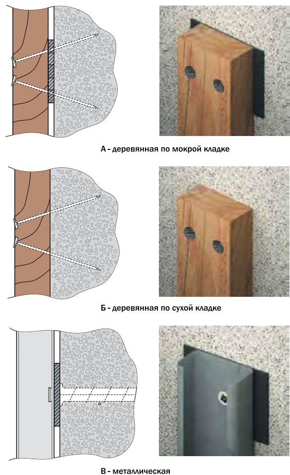
Рис. 9. Установка направляющих
