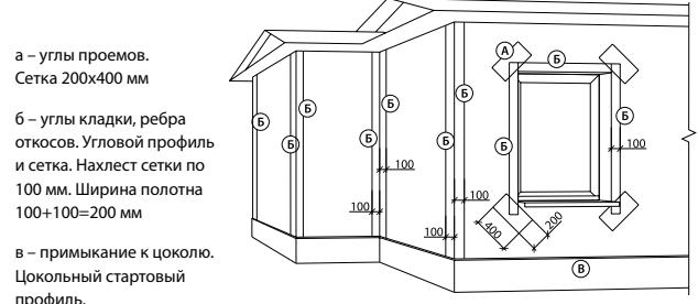
**ВАЖНО!** При устройстве верхнего откоса оконных и дверных проемов предусмотреть капельник.
