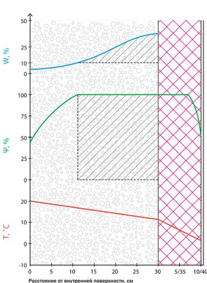
б2 – мокрое утепление по ППС 100 мм
