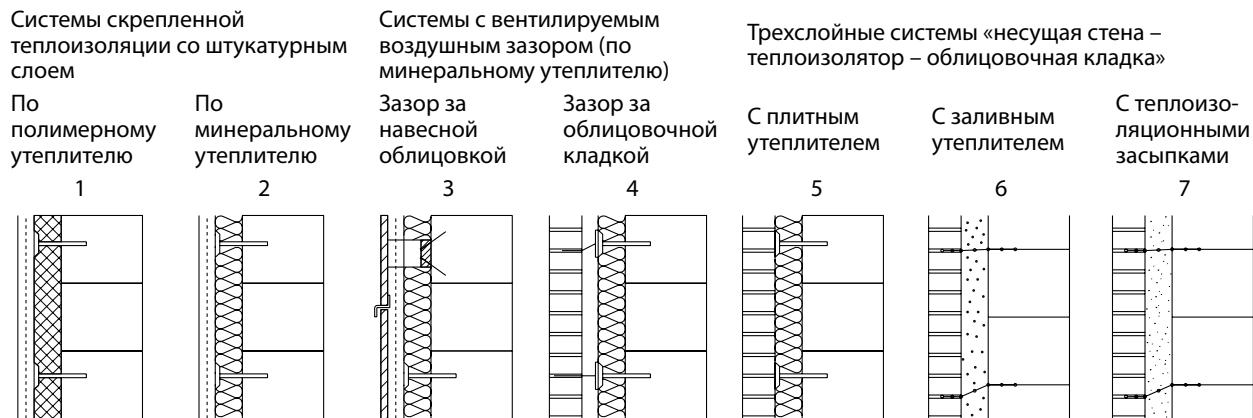
Рис. 18. Системы теплоизоляции
