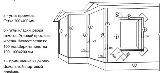
**ВАЖНО!** При устройстве верхнего откоса оконных и дверных проемов предусмотреть капельник.
