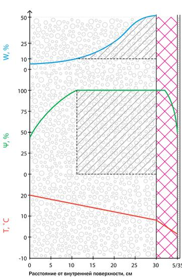
б1 – мокрое утепление по ППС 50 мм
