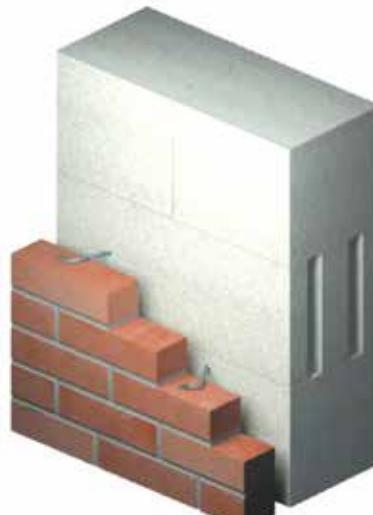
Рис. 7б. Облицовка с непосредственным креплением
