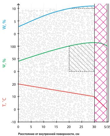
б1 – мокрое утепление по ППС 50 мм
