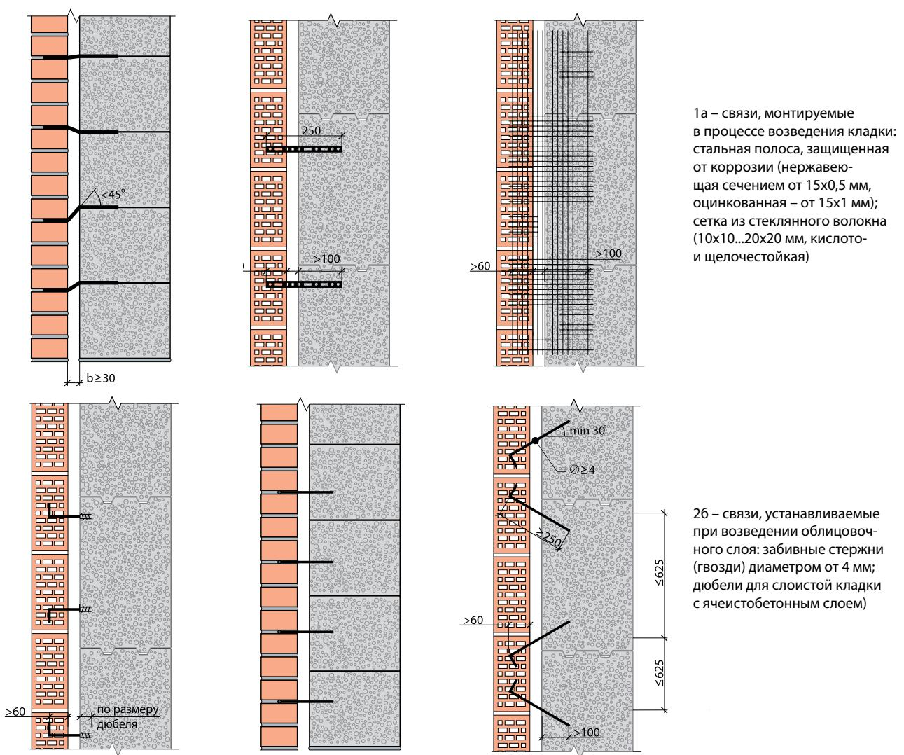
Рис. 14. Связь облицовочного и основного слоев кладки
