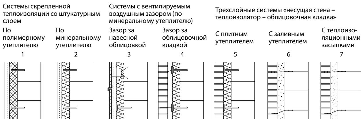
Рис. 18. Системы теплоизоляции
