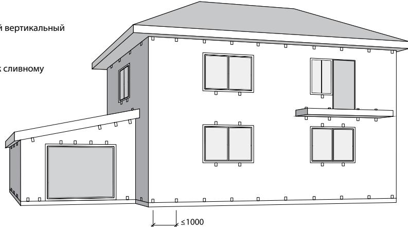
в – схема расположения вентиляционных и сливных отверстий
