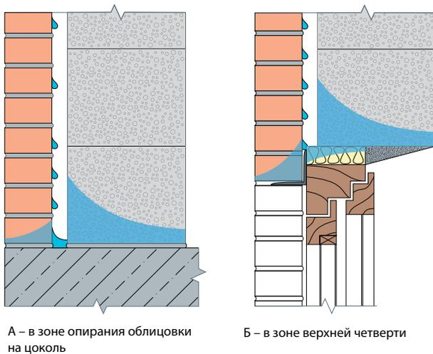
Рис. 8. Конденсат на внутренней поверхности облицовок. Зона потенциального увлажнения
