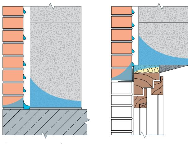
Рис. 8. Конденсат на внутренней поверхности облицовок. Зона потенциального увлажнения
