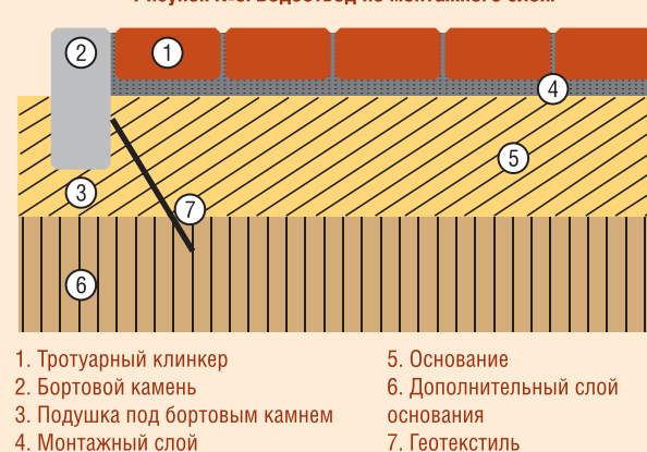
Рисунок №3. Водоотвод из монтажного слоя.
